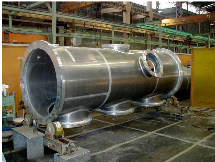
アルミニウム製ガス絶縁開閉装置 (GIS)
