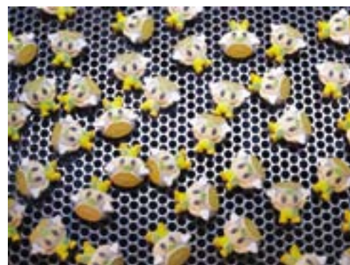
図4 全長22mm、200体のフィギュアを出力するのに要した時間は6時間。データ作成から、サンプル出力、本出力まで一日で終わることができた。
